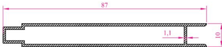
Profil N o : 1014 Ag ırık : 0,564 kg/m
